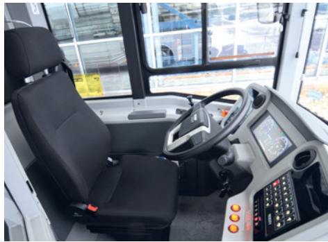
VDV-konform: Der Neocity-Armaturenräger lässt sich mit dem Lenkrad verstellen.
